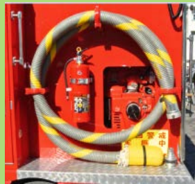
吸管・消火器
