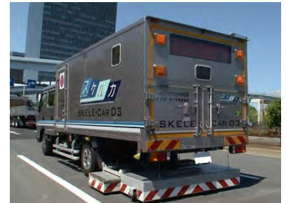
空洞探査車による調査
