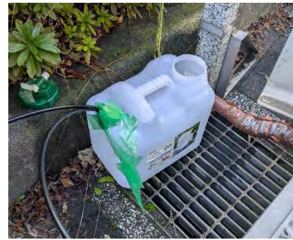
逆火防止のための水封処理
