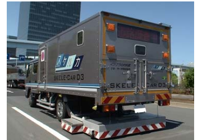
空洞探査車による調査
