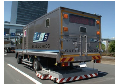
空洞探査車による調査
