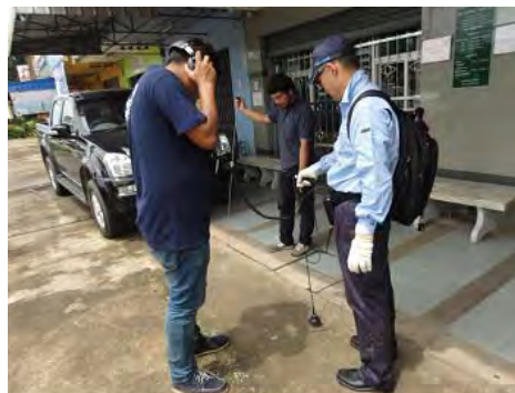
現地での漏水調査 (タイ)
