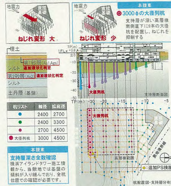
図3 傾斜地盤に対する基礎計画
