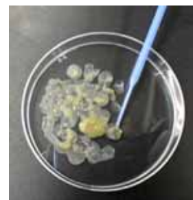
写真 浴場施設配管内から採取したバイオフィーム
