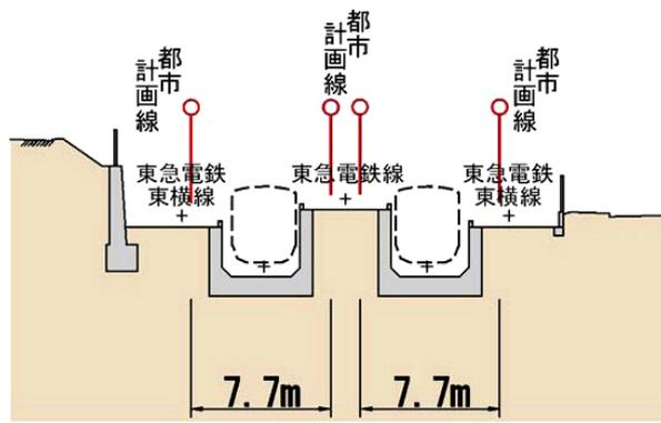
図 1.5-1(8) 擁壁（掘割）概略断面図
