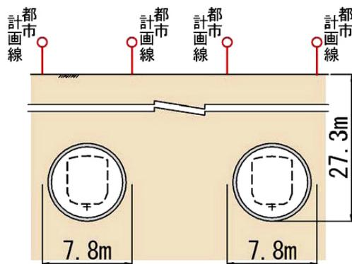
図 1.5-1(6) 円形トンネル（単線並列）概略断面図
