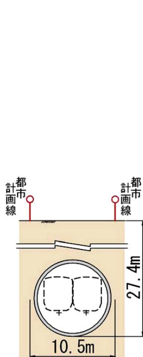
図 1.5-1(4) 円形トンネル（複線）概略断面図
