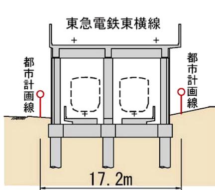
図 1.5-1(7) 高架橋 2 層概略断面図
