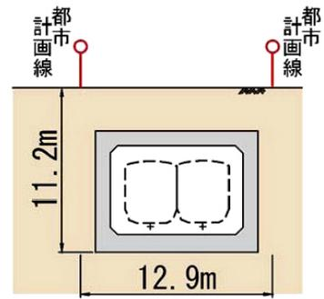
図 1.5-1(2) 箱型トンネル概略断面図
