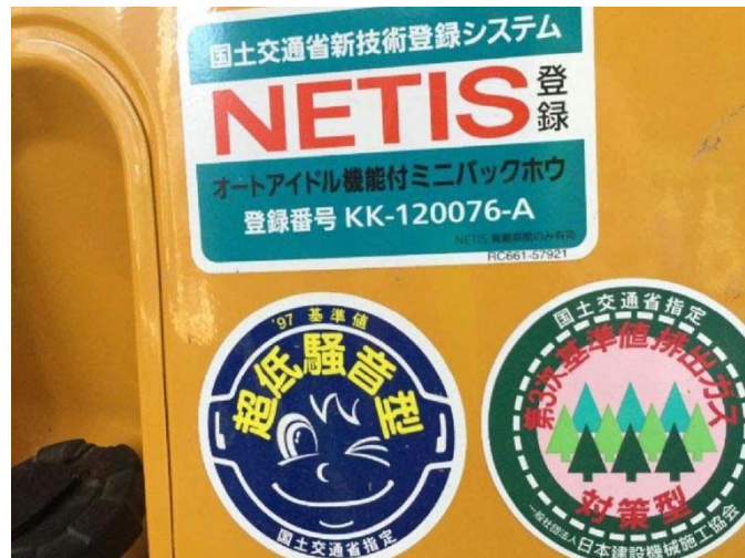
写真 2. 4. 4-4 環境保全のための措置の実施状況（環境対策型建設機械の使用）
