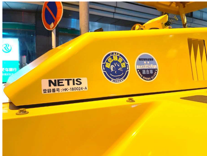
写真 2. 4. 4-3 環境保全のための措置の実施状況（環境対策型建設機械の使用）
