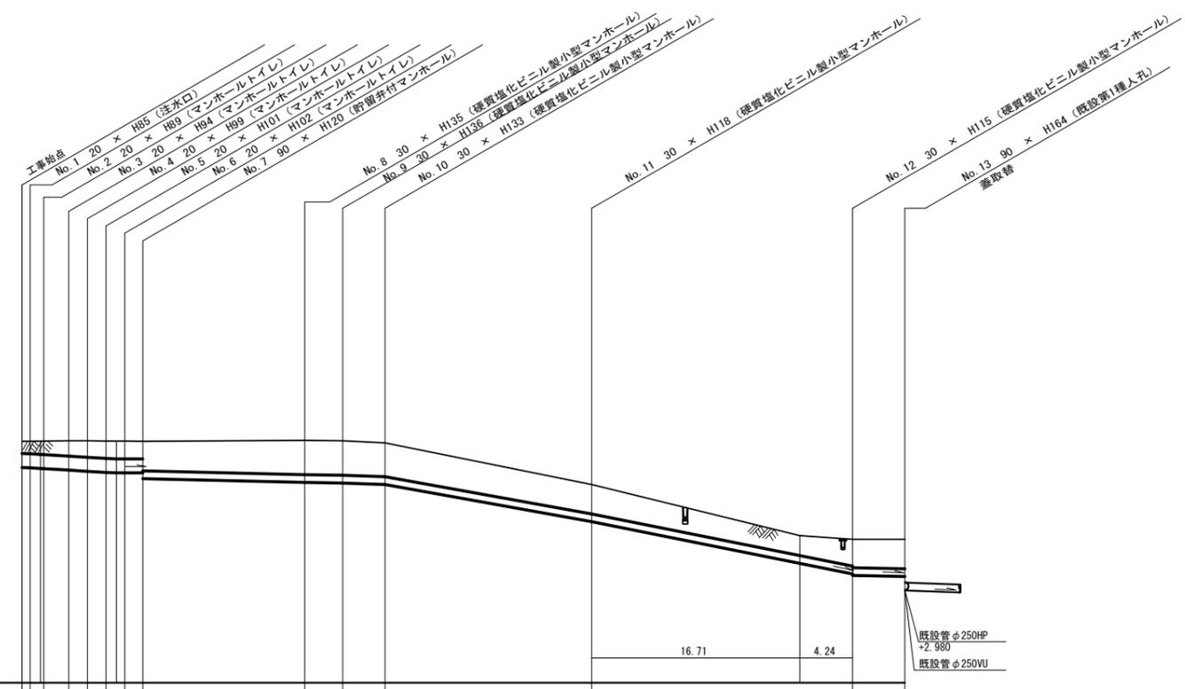
① 軽量鋼矢板1型 1段梁 平均長L=2.0m(全面)
