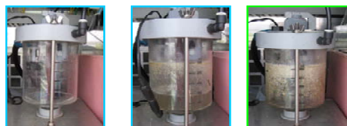
写真-3 計量マス内のスカム付着状況
