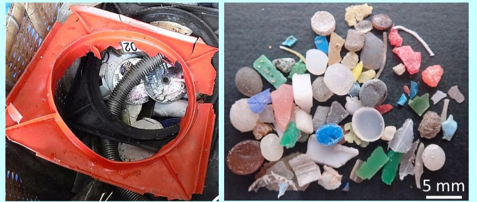
左：劣化したカラーコーンの断片、右：マイクロプラスチック
