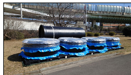
ダクタイル鋳鉄管（口径 1800mm）
