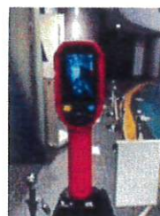
【サーモグラフィー】
