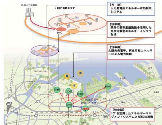
みなとみらい21地区における取組案イメージ（横浜市みなとみらい21地区スマートなまちづくり審議会資料より）
