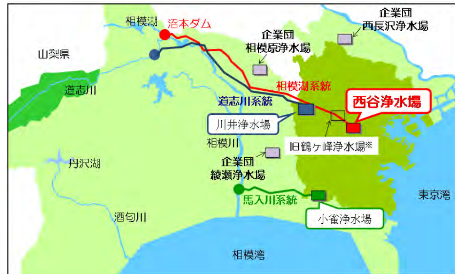
※老朽化のため平成 26 年 3 月に廃止し、現在、配水池として再整備中
