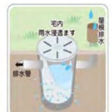
宅内雨水浸透ます
