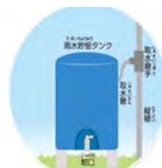
雨水貯留タンク
