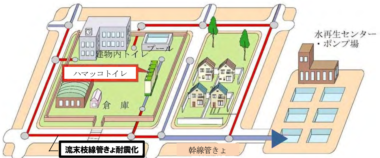
地域防災拠点等につながる流末枝線管きよ(赤線で表示)の模式図
