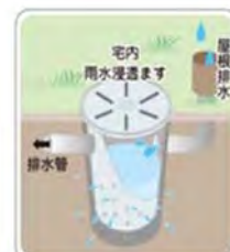
宅内雨水浸透ます
