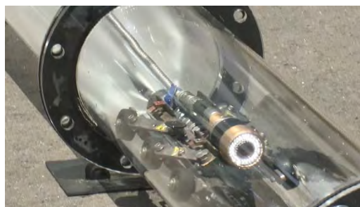
スクリーニング調査の実施(左、中：ノズルカメラ、右：撮影画像)
