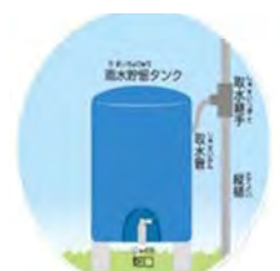
雨水貯留タンク
