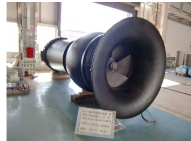
ポンプ再整備後
